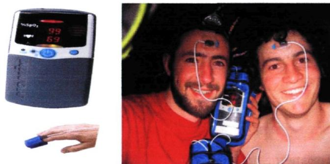
Figure 12 : Oxymètre PalmSat 2500 de Nonin avec capteur digital et frontal.
